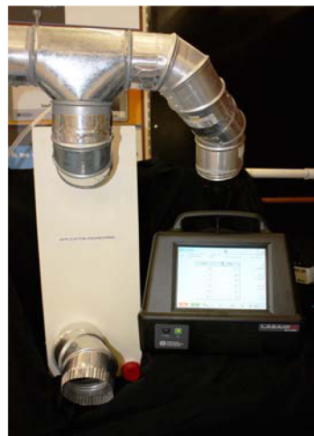
Figura 2 Unidade de referência Lasair III 5100 sob um suprimento de ar HEPA
